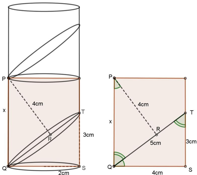
Seccionando el cilindro con el plano que contiene al eje del cilindro y al diámetro  $QS$  de la base, destacamos el rectángulo de lados  $PQ$  y  $QS$ . En el triángulo rectángulo  $QTS$ , por Pitágoras la hipotenusa  $QT$  mide  $5\text{cm}$ . Por ser los triángulos  $PQR$  y  $QTS$  semejantes, se obtiene la relación  $\frac{x}{5} = \frac{4}{4} = 1$ , es decir  $x = 5\text{cm}$ . El volumen del cuerpo es  $(\pi \times 2^2 \times 5)\text{cm}^3 = 20\pi\text{cm}^3$ .
