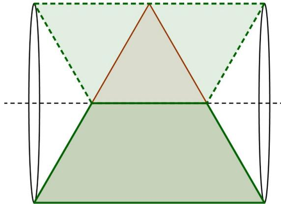
Como se aprecia en la figura precedente, el volumen puede obtenerse como el volumen de un cilindro menos el volumen de dos conos. Las alturas de estos conos suman una longitud igual a la mitad de la base del triángulo, en consecuencia los conos totalizan un volumen igual a  $1/6$  del volumen del cilindro, de modo que el cuerpo generado tiene por volumen a  $5/6$  del volumen del cilindro. El volumen del cilindro es:
