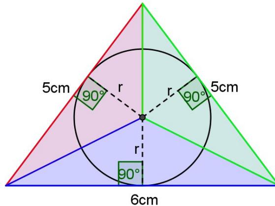
El radio de la esfera coincide con el radio de dicha circunferencia. Para encontrarlo descomponemos el triángulo antes mencionado en tres triángulos con un vértice común que es el incentro de dicho triángulo (punto de intersección de las bisectrices). El área del triángulo es  $12\text{cm}^2$ , también es la suma de las áreas de los tres triángulos:
