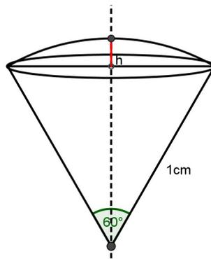
El área lateral del cono es  $\left(1 \times \frac{1}{2} \times 2\pi\right) \text{cm}^2 = \pi \text{cm}^2$ ; el área lateral del casquete es  $\left(2\pi \times 1 \times \left(1 - \frac{\sqrt{3}}{2}\right)\right) \text{cm}^2 = (2 - \sqrt{3})\pi \text{cm}^2$ . Luego el área del cuerpo obtenido es  $(3 - \sqrt{3})\pi \text{cm}^2$ .
