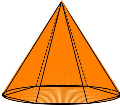
En consecuencia, usando Pappus, el volumen es  $\left(\frac{1}{3}\pi \times 3^2 \times 4\right) \text{cm}^3 = 12\pi \text{cm}^3$  y el área es  $\left(\pi \times 3^2 + 5 \times 2\pi \times \frac{3}{2}\right) \text{cm}^2 = 24\pi \text{cm}^2$ .
